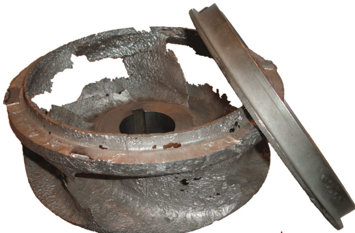
FOT. 2 Pierścień wirnika wykonany ze stopu Lewmet® i wirnik wykonany ze stopu Ilium 98
