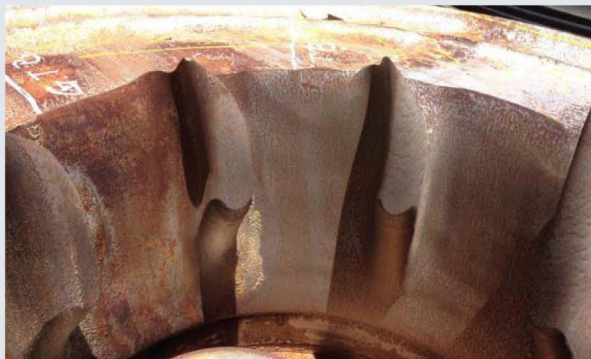
Rys. 9 – Łopatki do wstępnego zawirowania o wysokim stopniu zużycia na dnie rury wlotowej spowodowanego przez cząstki gruboziarniste
