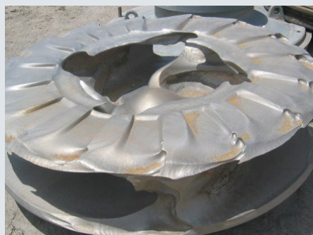
Rys. 1 – Zużyty wirnik pompy do parku młynów Warman® MCR®
