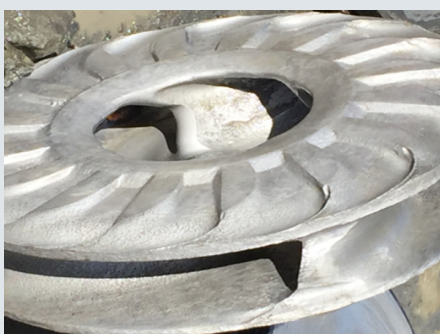
Rys. 2 – Wektory prędkości powodują turbulencję przepływu na krawędzi natarcia pod przednią częścią osłony wirnika.
