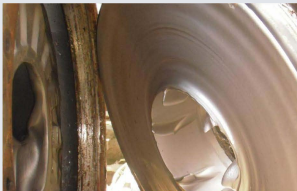
Rys. 8 – Typowe zużycie tulei wlotowej do wstępnego zawirowania oraz wirnika
